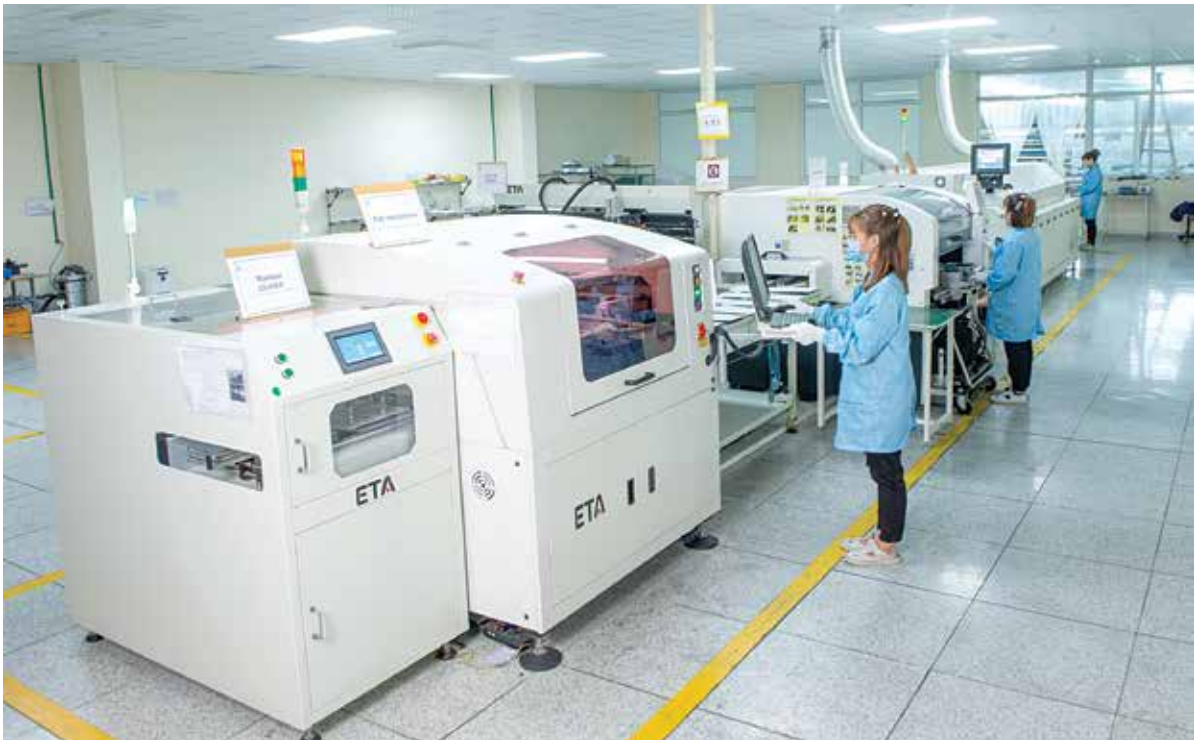
Dây chuyền gắn linh kiện tự động Automatic components mounting line for LED lighting
