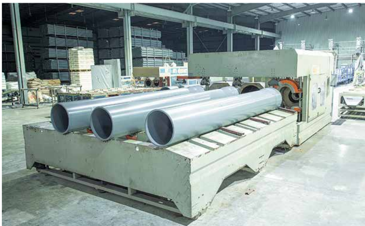
Dây chuyền sản xuất ống PVC - ROLLEPAAL PVC pipe extrusion line - ROLLEPAAL
