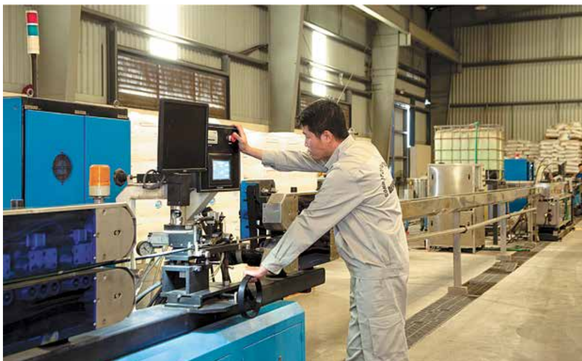
Dây chuyền sản xuất ống tưới nhỏ giọt Extrusion line for Dripping pipe
