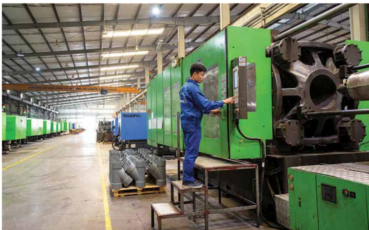
Máy ép phun phụ kiện PVC Injection machine for PVC fitting
