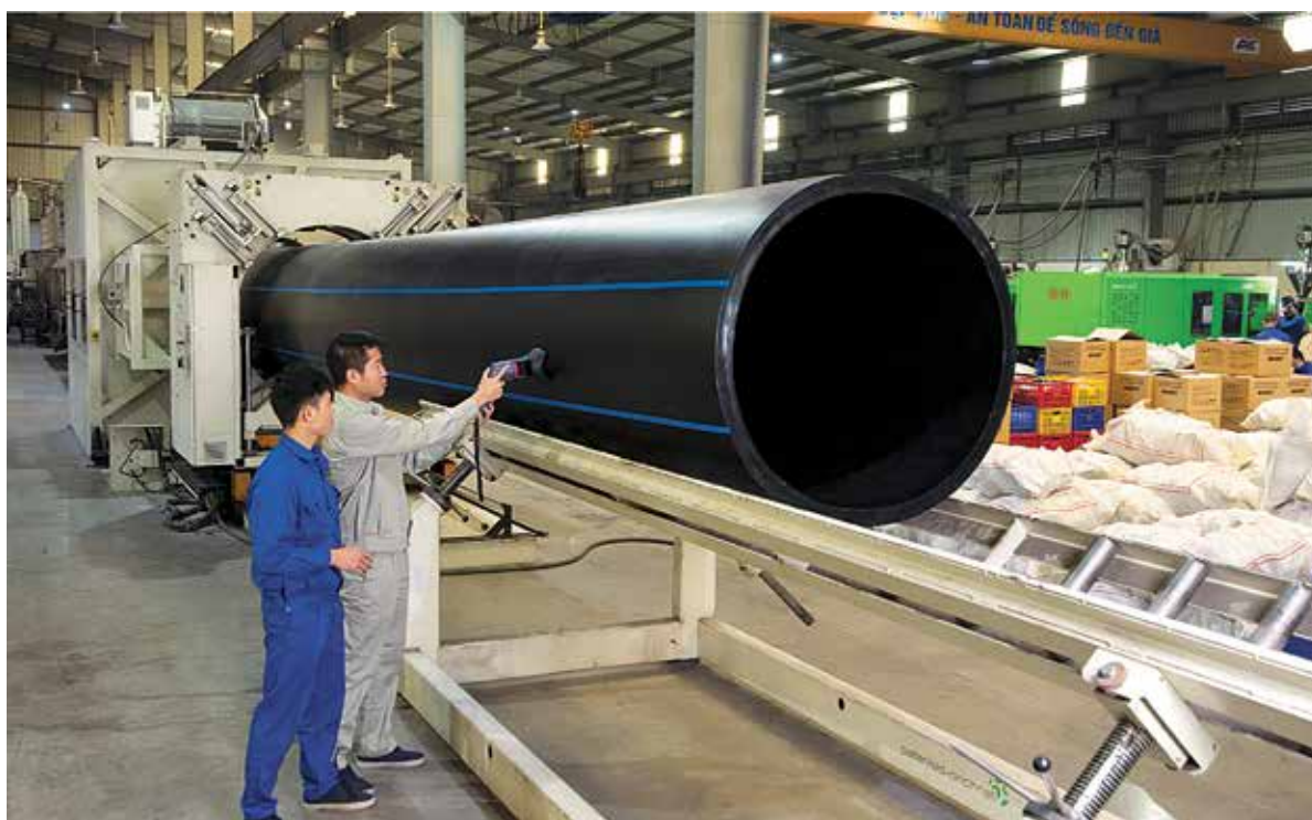
Dây chuyền sản xuất ống Ø1200 HDPE - CINCINNATI DN1200mm HDPE pipe extrusion line - CINCINNATI
