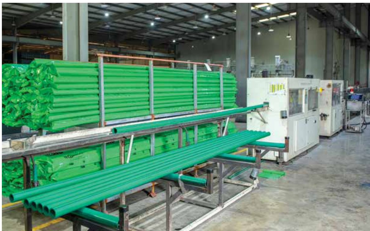
Dây chuyền sản xuất ống PPR - CINCINNATI PPR pipe extrusion line - CINCINNATI
