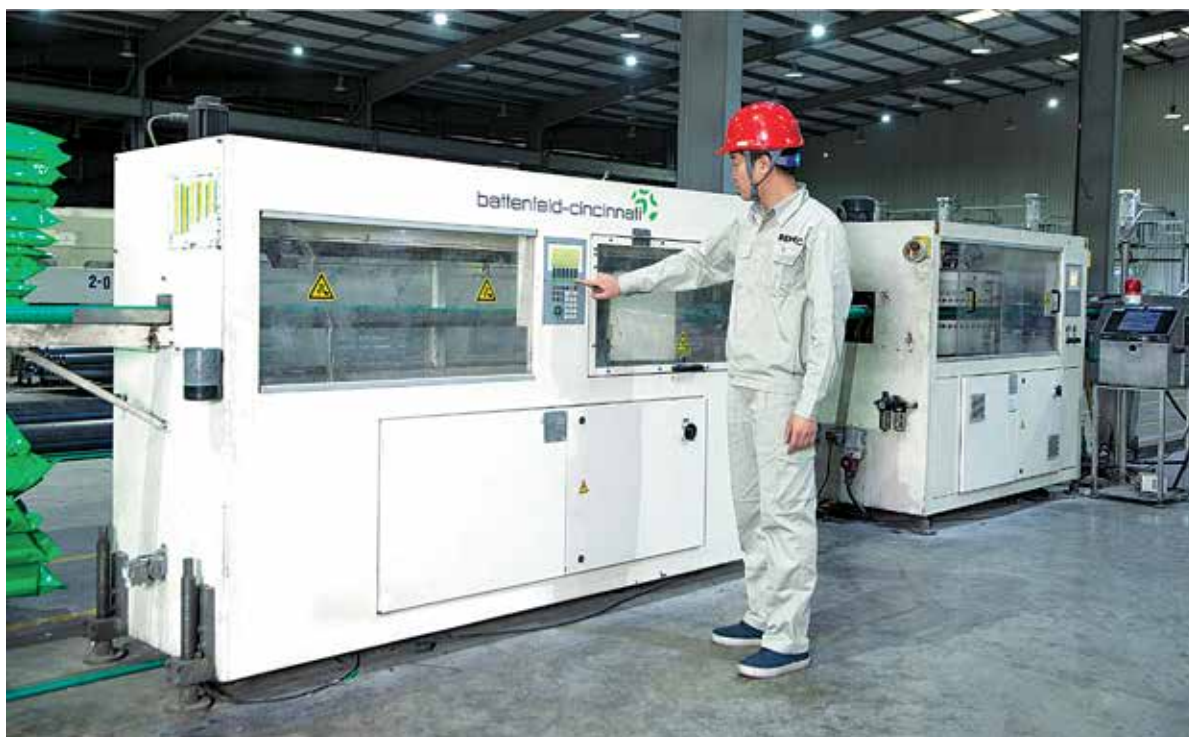
Dây chuyền sản xuất ống PPR - CINCINNATI PPR pipe extrusion line - CINCINNATI
